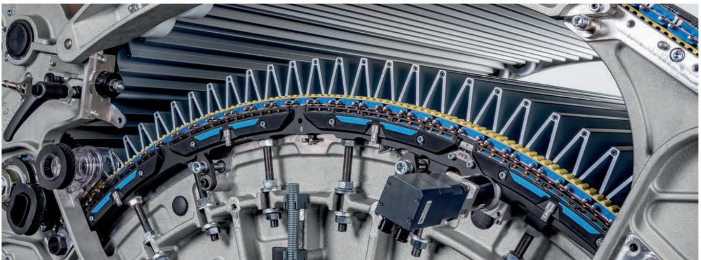
Die TC 19i mit Gap Optimizer T-GO ermöglicht deutliche Qualitäts- und Produktivitätssprünge, die den Energiebedarf pro Kilogramm Kardenband reduzieren
